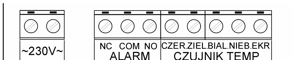
Rys. 1: Rozmieszczenie zacisków połączeniowych termometru.
