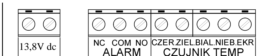
Rys. 1: Rozmieszczenie zacisków połączeniowych termometru.
