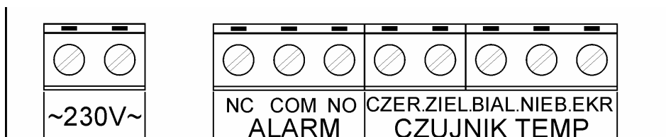
Rys. 1: Rozmieszczenie zacisków połączeniowych termometru.
