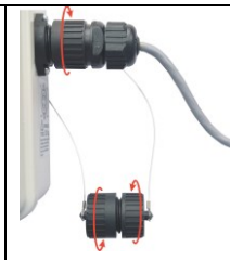
Schemat podłączenia modułu szalki z wtykiem hermetycznym.
